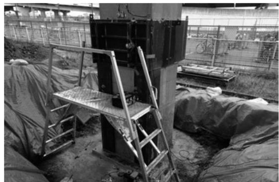
図5 吊り架構接合部の現地振動測定状況
