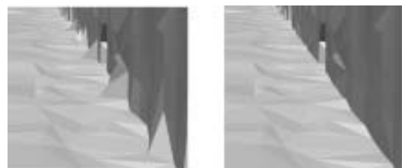
b) トンネル隅部分拡大（左：一括生成 右：修正）
