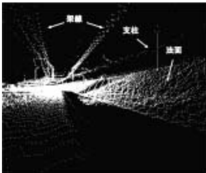
図6：線路周辺形状（法面・支柱・架線）
