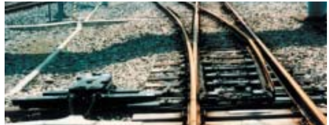
図5：転てつ機(左)と分岐器(右)
