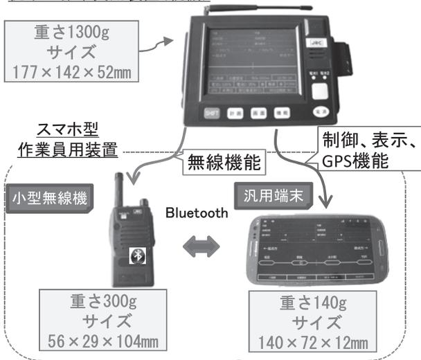
図8 作業員用装置（親機）の小型軽量化
