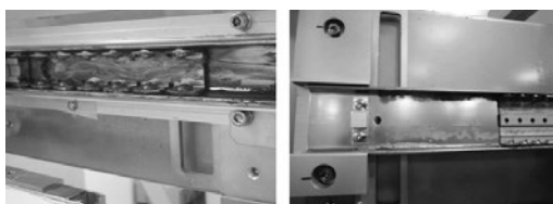
図5 スライドレールの汚損を模擬した状態
