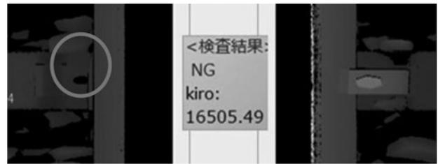
図10 レール締結装置の脱落画像
