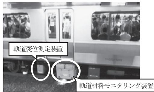
図2 営業列車搭載型線路設備モニタリング装置の稼働外観
