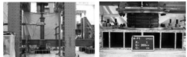
図4 試験体全景(左)、軸力導入後の積層ゴム(右)
