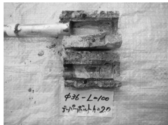
図8 荷重後の充填材内部 (H/D=2.0)
