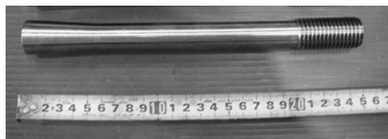
図3 テーパ型先端定着体の形状
