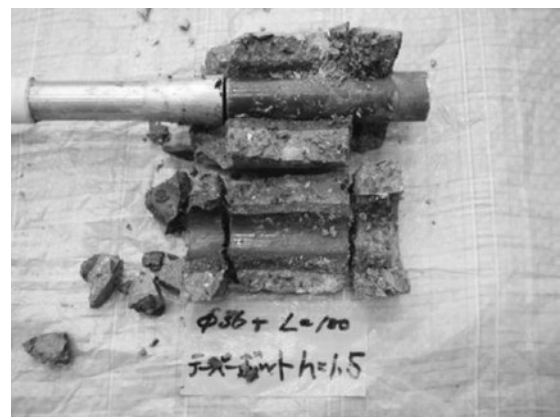
図7 荷重後の充填材内部 (H/D=1/1.5)
