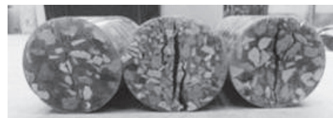
図3 圧縮強度試験後の供試体
