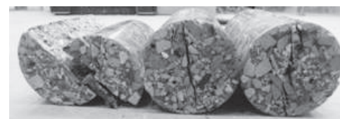
図4 引張強度試験後の供試体
