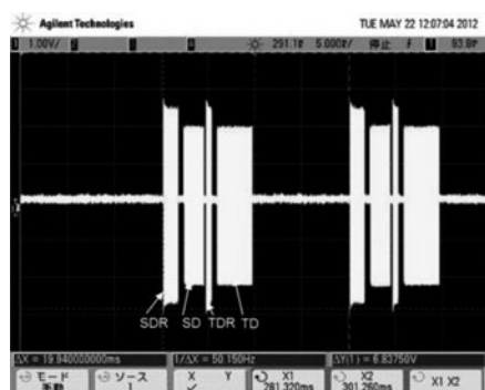
図7 ドア情報集約部-戸閉制御装置間伝送結果
