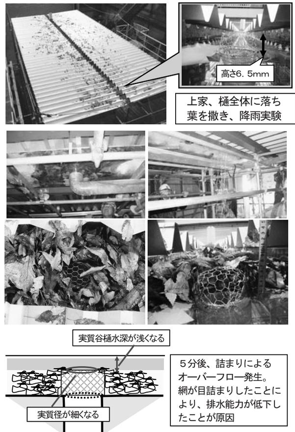
図14 落ち葉などによる樋の詰まり実験
