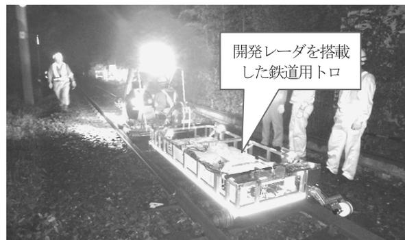
図7 営業線での性能確認試験状況
