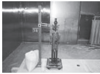
図5 引抜試験状況
