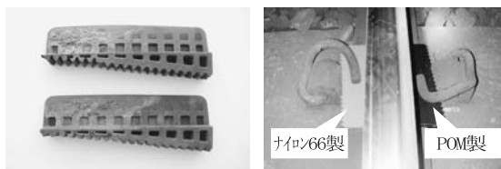
図3 摩滅した楔形インシュレータ（左）とナイロン66製およびPOM製の楔形インシュレータ（右）
