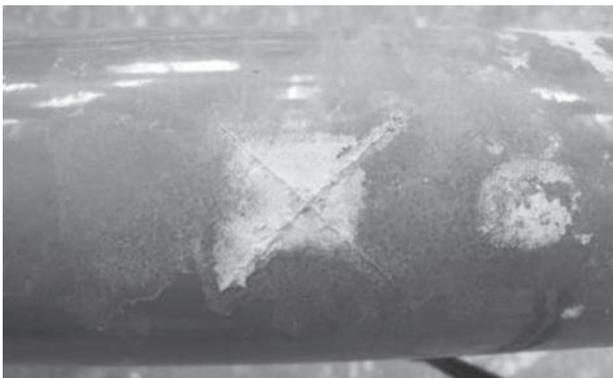
図9 粉体塗装+亜鉛めっき クロスカット部
