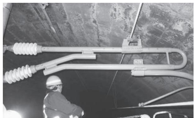
図12 フィールド試験中の試作品 (トンネル区間)
