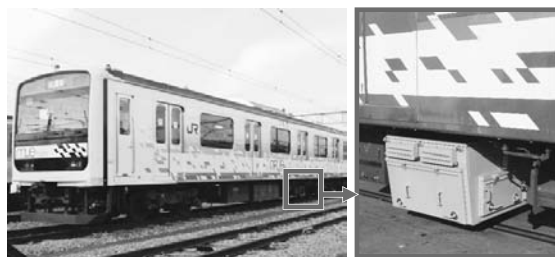
図5 材料モニタリング装置の設置状態
