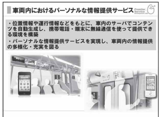
この車両内情報提供サービスでは、我々は電車がどちらの方向にどのように進んでいるのかという情報がわかりますので、お客さまから見ますと位置情報、運行情報に基づいたかたちで情報提供を得ることができます。システム的には位置情報や運行情報を車内に設置したサーバに伝送し、そのサーバからお客さまの携帯電話もしくはスマートフォンに情報提供されるという仕組みになっています。
