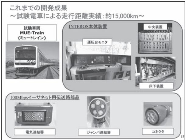
最後になりますが、開発としてはこのようにINTEROSの本体装置、モニター、中央装置、床下装置、100Mbpsのイーサネットという信号を通すための電気連結器、ジャンパ連結器、コネクタといった部品を対象に行いました。これらを試験電車MUE-Trainに搭載し、約1年3か月で15,000kmの走行を積み重ねてきています。是非次期通勤車両にINTEROSを搭載したいと考えています。
