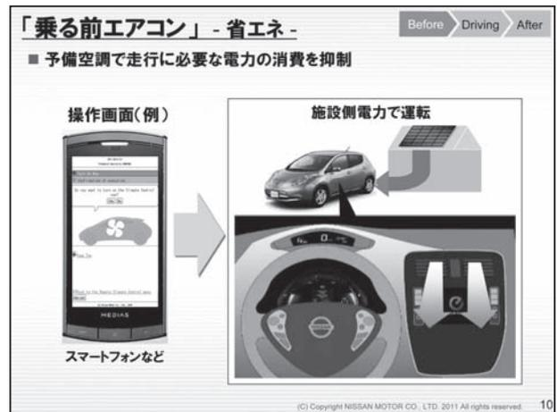
そこで、この「乗る前エアコン」という機能を提供しています。エアコンというのは通常、外気温とのギャップを埋めるために起動直後にエネルギーをかなり使います。この段階で車のバッテリーの電力をできるだけ使いたくないのですが、この「乗る前エアコン」という機能は、車に乗る前にパソコン、スマートフォンなどから、バッテリーの電力を使わずに、家の電力を使ってエアコンを起動させておくことができる機能です。これによって、車に乗った時にはもう既に安定温度になっていますので、走行中はほとんど温度を維持するためだけのエネルギーしか使わないということになり、省エネルギーが実現できるということになります。
