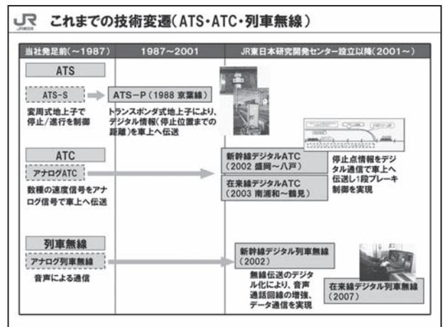
次にATS、ATCおよび、列車無線についてご説明いたします。ATSにつきましては、国鉄時代はATS-Sとして、基本的に停止信号を制御するという方式を使っておりました。その後1998年京葉線を初めとして、ATS-Pを導入しました。ATS-Pは、停止位置までの距離を地上サイドから車上へ送ることによって、車上で速度パターンを認識し、確実に停止位置に停車させるという仕組みです。これにより、安全性が飛躍的に向上したと考えています。
