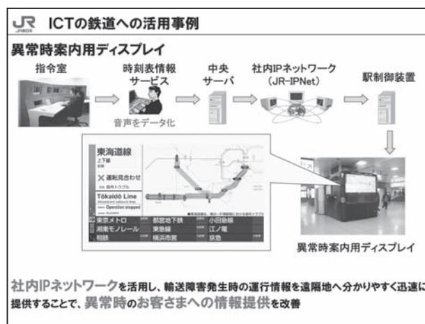
第四に、ICTのその他の技術への活用例をご紹介します。これは、異常時案内用ディスプレイの概念図です。このシステムは、指令室の情報を時刻表の情報サービスセンターでデータ化して、中央サーバー、IPネットワーク装置などを介し、駅に設置しているディスプレイに表示する仕組みです。路線図に情報を表示しており、視覚的に情報が得られることから、お客さまより好評を博しています。
