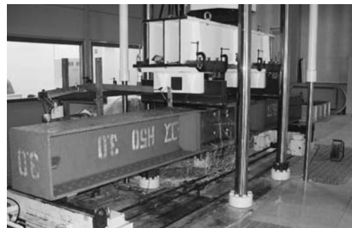
図8 主桁静的載荷試験状況
