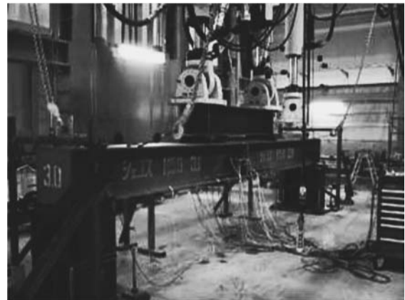
図20 繰り返し荷重試験実施状況
