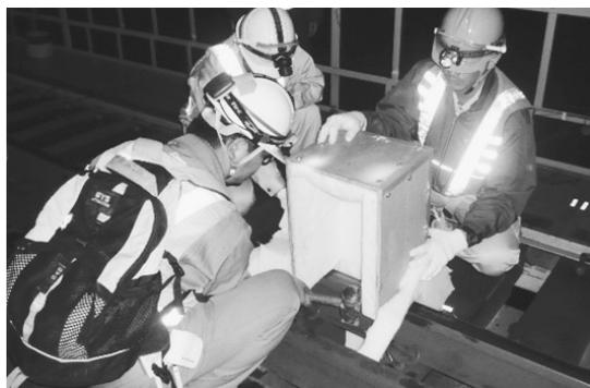
図4 レール加振試験
