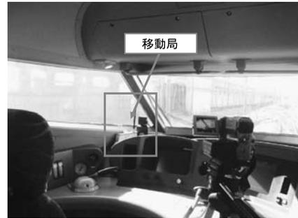
図10 運転台における移動局設置状況
