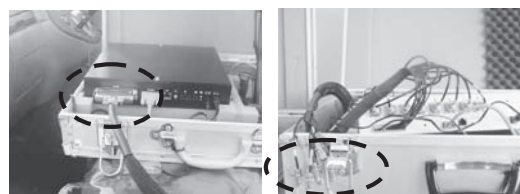
図8 接続コネクタの改良（左：改良機、右：従来機）
