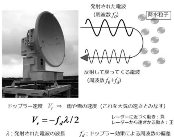
図2 ドップラー気象レーダーの原理
