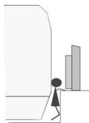
図4 ホーム隙間への転落(宙吊り状態)
