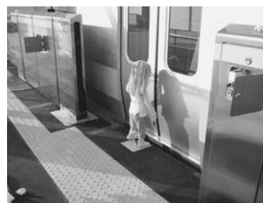
図11 検知試験風景 (居残り)
