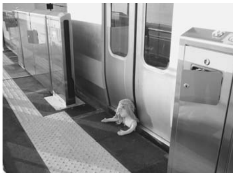
図13 検知試験風景（車両とホーム隙間への転落）
