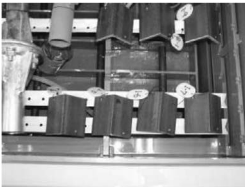
図2 経年算出用テストピース
