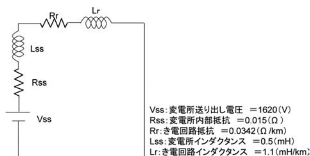
図11 完全短絡等価回路
