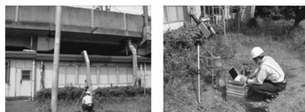
図7 Uドップラーによる振動測定状況
