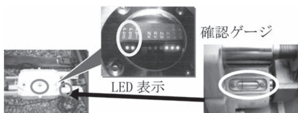
図2 LED表示・確認ゲージによるロック調整支援
