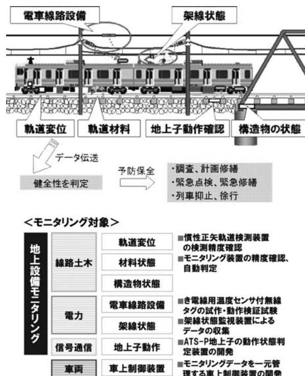
図3 営業車による地上設備モニタリングの概要と研究開発の状況
