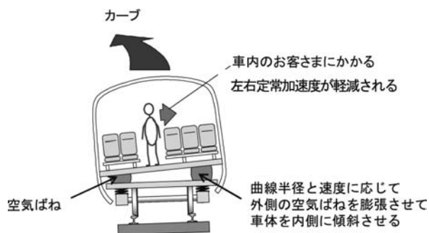
図10 空気ばねストローク式車体傾斜制御概念図
