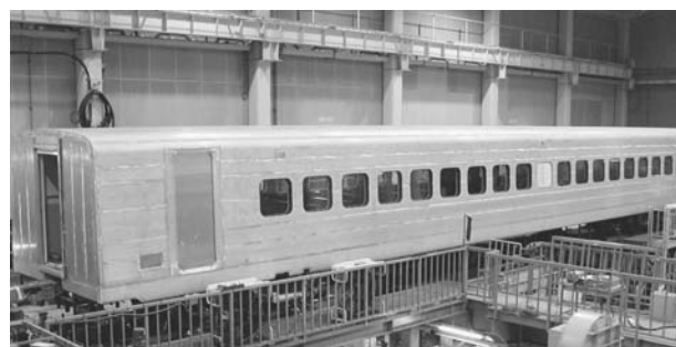
図10 車両試験台試験（鉄道総研）
