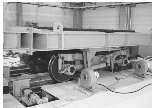
図13 長期耐久試験（台車試験装置）
