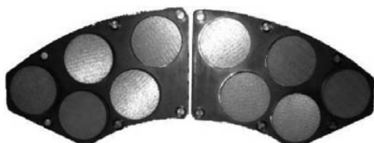
図12 分割式ライニング (B) の外観
