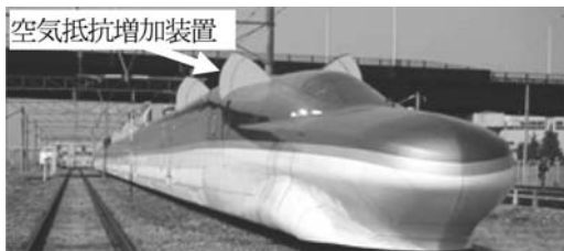
図3 空気抵抗増加装置外観 (E954)
