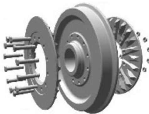
図6 現行ディスクの構造 (内周締結)
