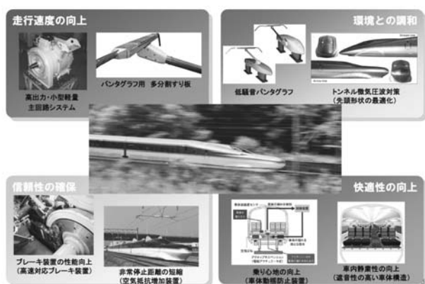
図8 FASTECH360の主な開発項目
