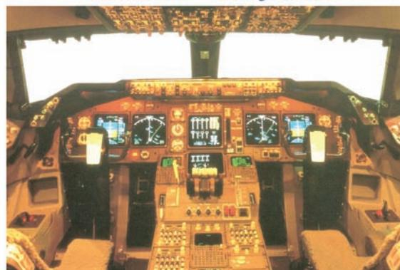
それに対して、最近ではグラスコックピットです。情報獲得のためのパイロットのワークロードを軽減するため、ディスプレイを使った統合型計器によって複数の情報を集約して表示しています。これはインタフェースのデザインとしては非常に大きな改善だと思われます。
