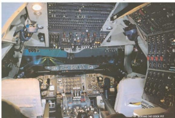
この図はボーイング747、いわゆるジャンボの古典的なコックピットです。一つのセンサーに一つのインジケーターが張り付いている形になっており、情報があちこちに散在してしまっています。特に、離着陸時にパイロットは100個程度の計器をずっとスキャンしながら飛ばしているという状況がありました。
