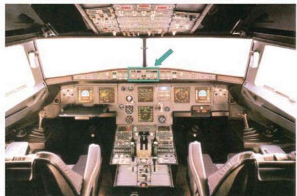
エアバス320のコックピットにおいて緑枠で囲んだ部分が人間とコンピュータがインタラクトするところです。この部分を拡大したものが次の図です。
