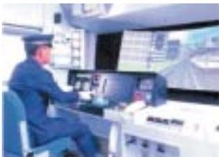
図2：事故予防型シミュレータによる訓練
