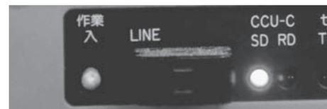
図9 停電検知センサの「作業」スイッチ
