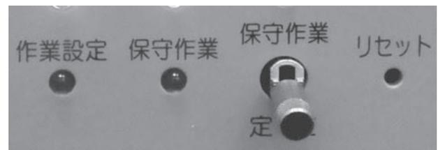
図8 接点センサの「保守作業」スイッチ
