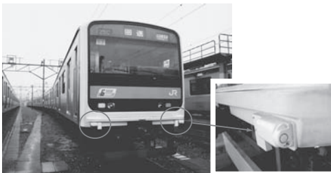
図1 超音波センサの車両設置位置
