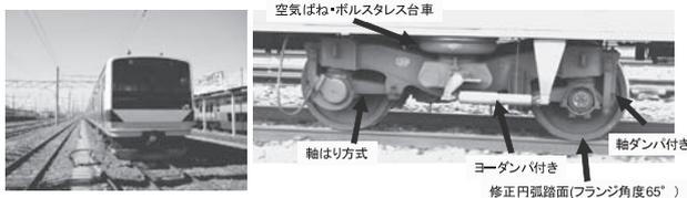
図2 E531系電車の台車の特徴
