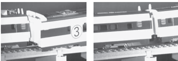
(a) 中間車 第1軸脱輪 (b) 中間車 第4軸脱輪
