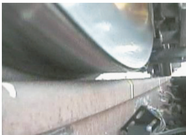
図1 尾久駅構内で実施した再現試験による乗り上がりの状況
