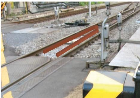
図2 逸脱防止ガードの設置イメージ
