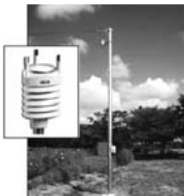
図11 高密度地上気象観測装置 (風向風速、気温、気圧、降水量、湿度を測定可能)
