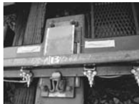
図19 高床式床板上下板、ばねクリップセンサー取付
