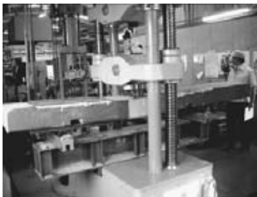
図14 横まくらぎ（合成）の曲げ試験
