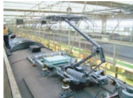
図3 パンタグラフ・測定器取り付け状況
