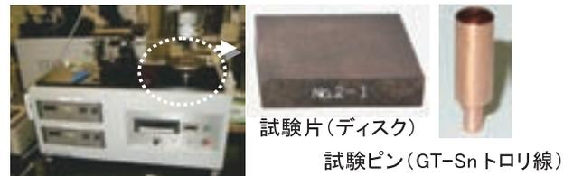
図12 ピンオンディスク型すべり摩擦試験装置
