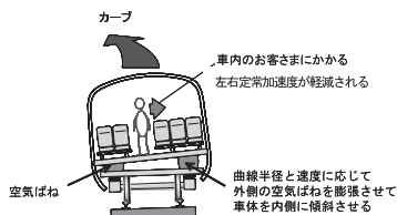
図12 空気ばねストローク式車体傾斜制御概念図
