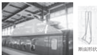
図20 「FASTECH360S」に搭載した30°改良形遮音板
