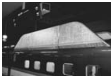
図13 「FASTECH360S」に搭載したZ形遮音板
