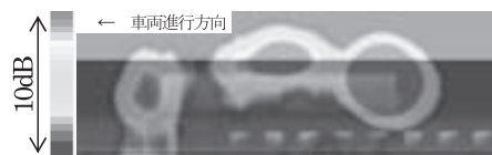
図7 遮音板付近の音源分布測定結果（2号車付近 O.A.値）
