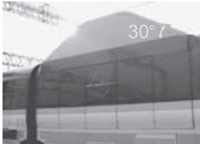
図19 可動式パンタグラフ遮音板（「FASTECH360Z」）
