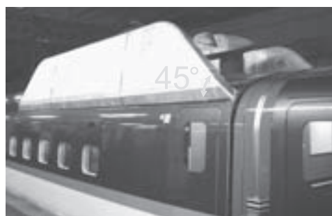
図13 平板形パンタグラフ遮音板（45度タイプ）
