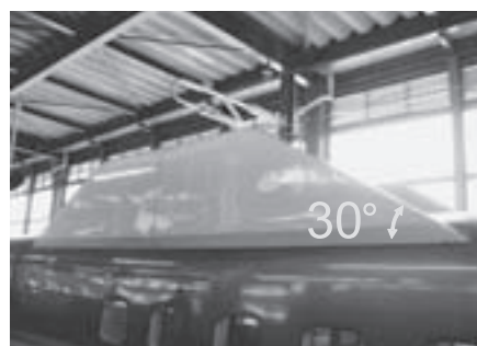
図16 平板形パンタグラフ遮音板（30度タイプ）
