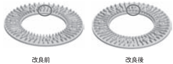
図11 ブレーキディスク冷却フィンの騒音対策
