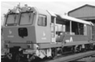
図1 大形保守用車の例、マルチプルタイタンバ
