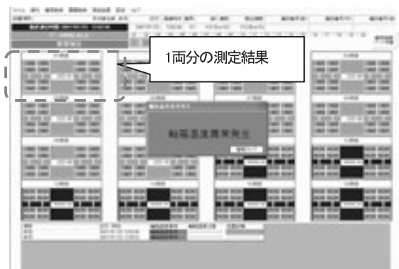
図5 測定結果表示画面（軸箱異常発熱検出時）
